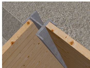
Räumliche Darstellung mit Spundwand und Böschungsverschnitten
